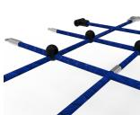
Cuerdas reforzadas de acero galvanizado en caliente recubiertas por fibras de polipropileno con tratamiento térmico de inducción para reforzar la unión entre la cuerda y el acero, aumentando significativamente su resistencia. Accesorios de fijación de plástico Brago HDPE con protección U.V., elementos de fijación de acero galvanizado en caliente.
