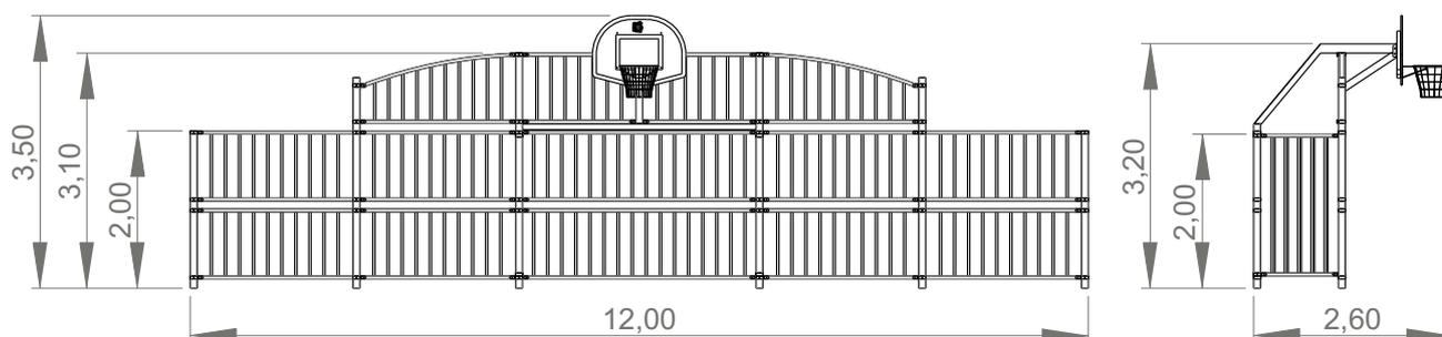
Utilização do equipamento sujeito a condições vigiadas; Zona de segurança: Área mínima requerida pela norma EN 1176-1,6
