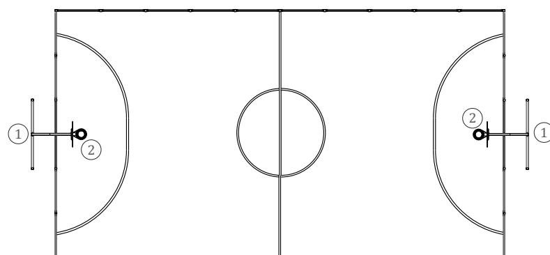
Utilização do equipamento sujeito a condições vigiadas; Zona de segurança: Área mínima requerida pela norma EN 1176-1,6
