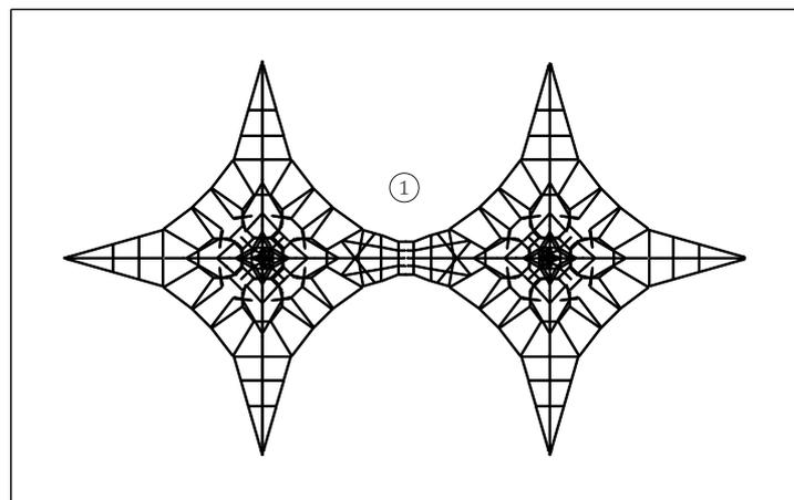
**Rede:** cordas Ø16mm reforçadas em aço revestido por fibras de polipropileno, acessórios de ligação e fixação em plástico HDPE com protecção U.V., elementos de fixação em aço galvanizado a quente;
